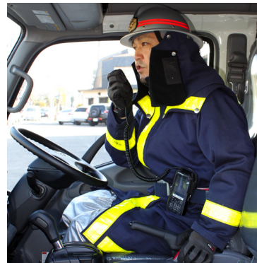
現場の消防団員はIP無線機を防水カバーに収めて腰ベルトに固定、さらに防水型ハンディマイクを使って通話する
