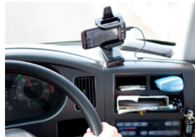
ダッシュボード上に設置されているスマートフォン。急ブレーキ、急発進、急カーブを記録できるドライブレコーダーとして活用されています。
