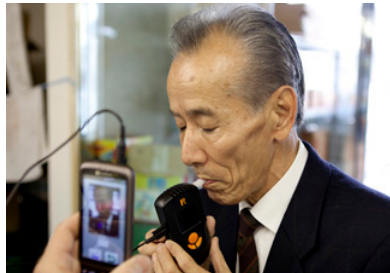
アルコール濃度を呼気から測定するため、ストローから息を吹き込みます。ドライバーの顔をスマートフォンのカメラで同時に記録できるため、別人の成りすましを防止できます。
