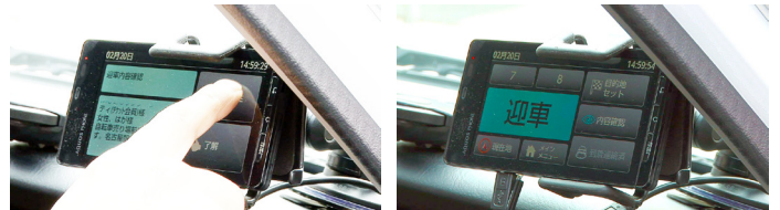
タクシーに搭載されているスマートフォン画面。配車指示が文字と音声で届く。「内容確認」ボタンをタップすれば詳細情報が確認できる。ステータスも「空車」から「迎車」に変わる
